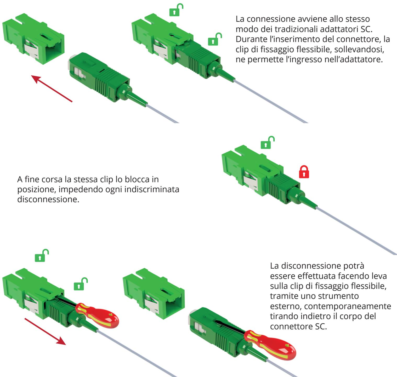
La connessione avviene allo stesso modo dei tradizionali adattatori SC. Durante l'inserimento del connettore, la clip di fissaggio flessibile, sollevandosi, ne permette l'ingresso nell'adattatore.
